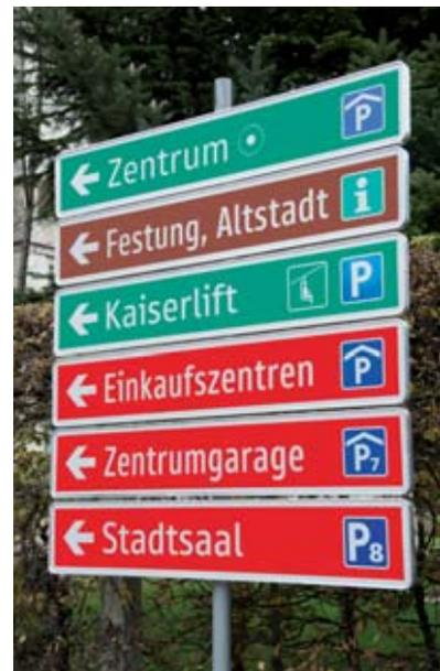
Die Wegweiser für das Parkleitsystem wurden in der Signalfarbe Rot mit weißer Schrift ausgeführt.
